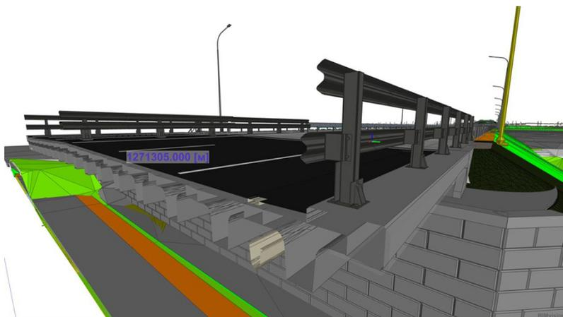
Рис. 1. Сечение информационной модели для контроля увязки проектных решений
